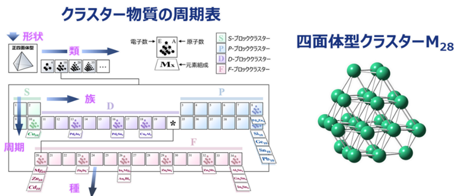
図 5 四面体型クラスターの予測を行う「クラスター物質の周期表」理論 (左) と、設計した四面体型クラスターのモデル構造 (右) (精密な量子化学計算では四面体型クラスターは若干歪んだ構造をとる)
