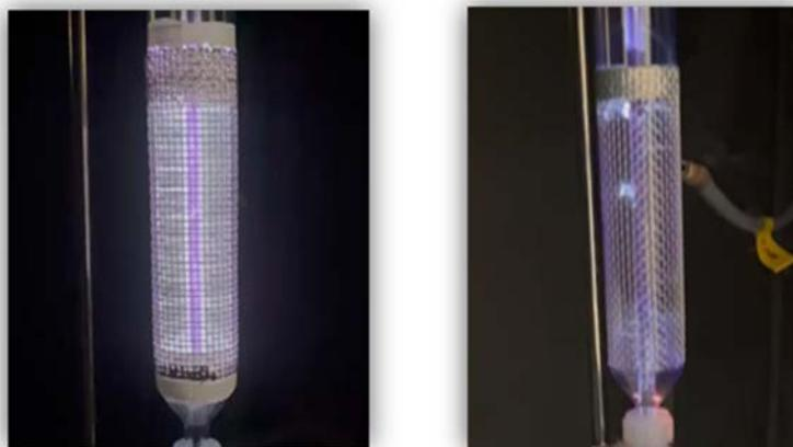
図3 粒子充填した場合の層内プラズマの様子（左：無充填，右：粒子充填（30 g））
