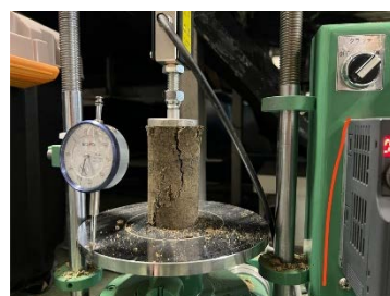
写真-2 一軸圧縮試験
