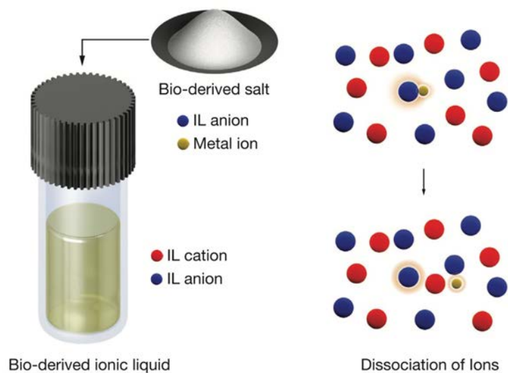
図 7 イオン液体への Na イオンのドーピング
