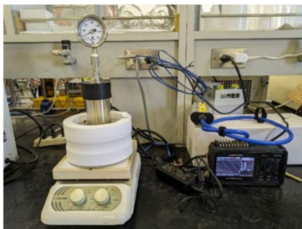
図1 ヘキサクロロベンゼンの乾式分解の様子
