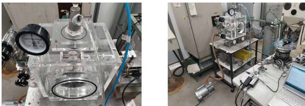
図 3 本研究で作製した処理システム（左はチャンバ、右は全景）
