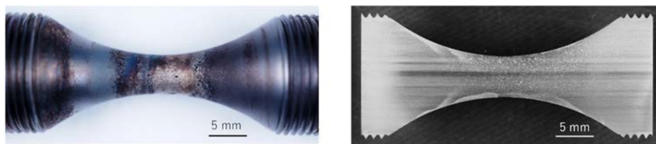
図 12 環境親和型浸炭処理を施した SCM420H 鋼の被処理面のマクロ観察
