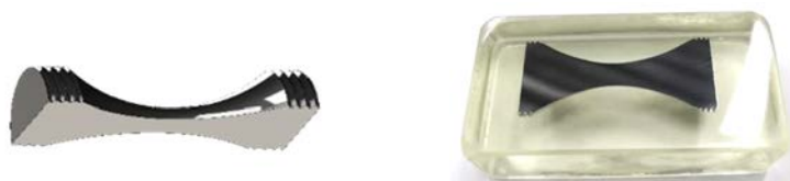
(b) 断面の分析（組織観察・硬さ測定）
