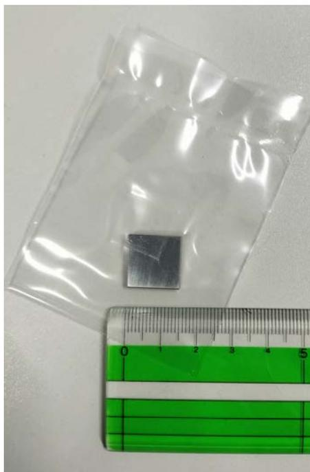
図6 水素プラズマジェットによる直接還元検証のために製作した純鉄の試験片（表面を研磨し密封処理を施した）
