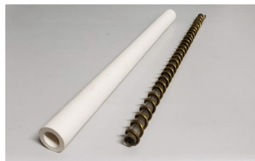
Fig.2 10μm セラミック フィルターと巡回ロッド
