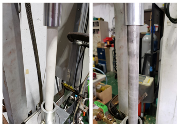
Fig.8 エマルジョン流通前後のフィルターの様子 左:新品フィルター 右:分離後
