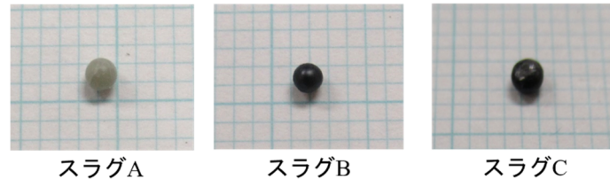
図 10 冷却後のスラグ試料 A, B, C の外観写真 (試料名は表 2 中の表記と対応)
