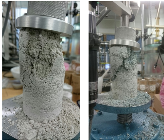
図 12 高炉水砕スラグの破壊形態（左：30 日養生後，右：90 日養生後）
