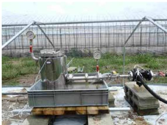
図7 ヒートパイプ装置
