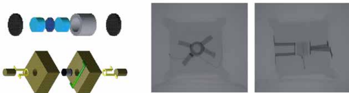
図 6. 試料セルの断面と試料セルの組立、写真はボロンエポキシ圧力媒体に封入後の X 線像
