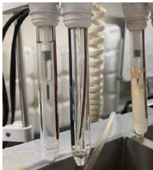
図 2 非メンテナンス pH 計 (写真右), メンテナンス pH 計 (写真左), メンテナンス ORP 計 (写真中央)
