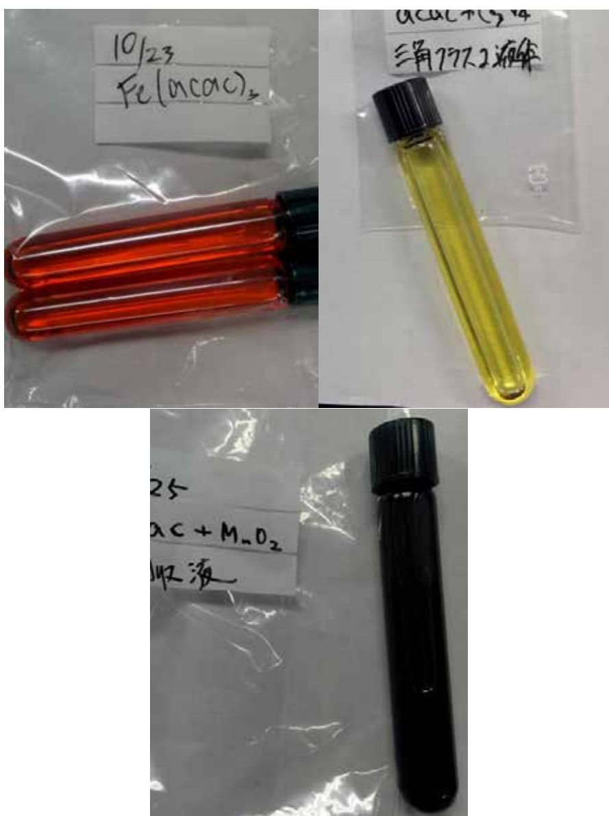
Fig. 3 回収した液（反応させた酸化物は左上から \text{Fe}_2\text{O}_3 、 \text{Co}_3\text{O}_4 、 \text{MnO}_2 ）
