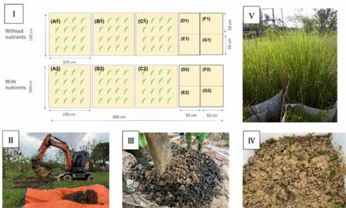
図 2 フィールド試験の様子 I：実験レイアウト，II：土壌掘削の様子，III：混合土壌とマイクロマグネタイト，IV：植栽されたベチバー（初期），V：ベチバー成長の様子
