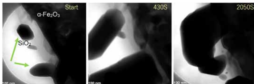
図 1 ヘマタイトとシリカを重ね合わせて TEM 内で 600^\circ\text{C} に保持し、その変化を録画した VTR からキャプチャーした連続写真 (それぞれ左から録画開始、430 秒後、2050 秒後、矢印で示しているのは初期の鉄析出物)
