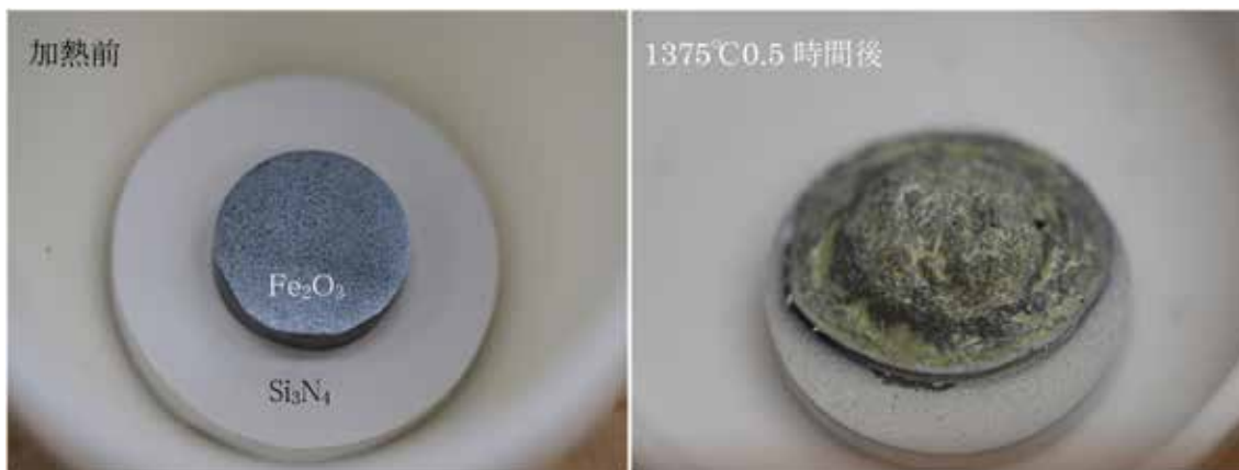
図10 窒化ケイ素ロッド上にヘマタイトのロッドを乗せて1375°Cで0.5時間保持した前後の写真(窒化ケイ素は直径20mm、ヘマタイトは直径10mm)
