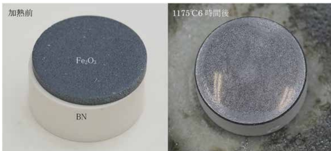
図 6 窒化ホウ素の上にヘマタイトのロッドを乗せて 1175°C で 6 時間保持した前後の写真 (ロッドの直径は 10mm)
