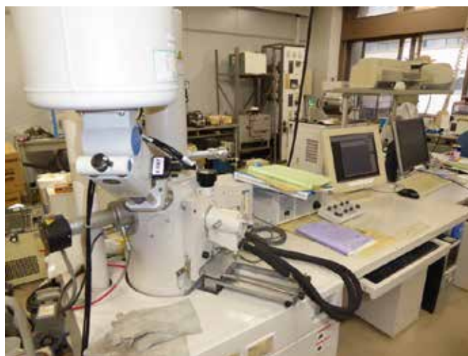
図6 SEM及びEDX装置外観
