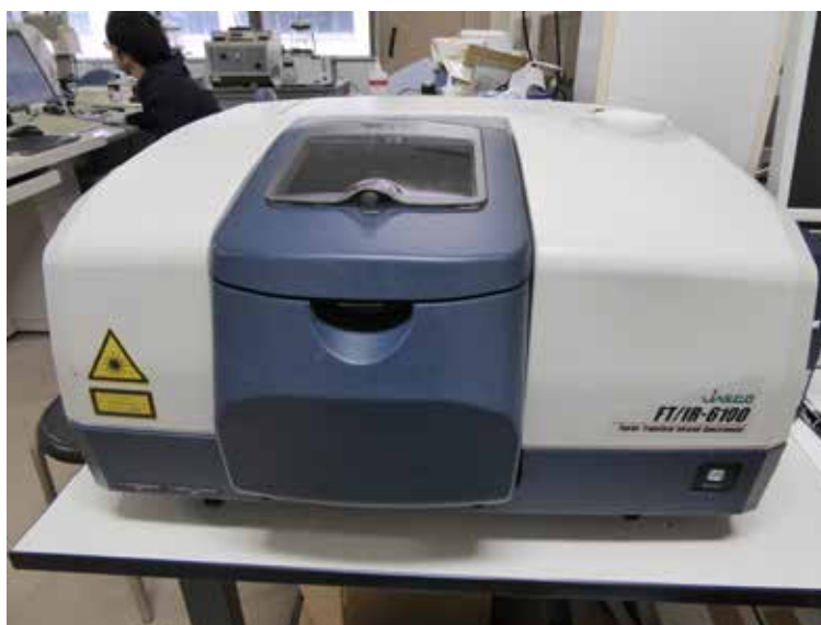
図 5 FT-IR 装置の外観
