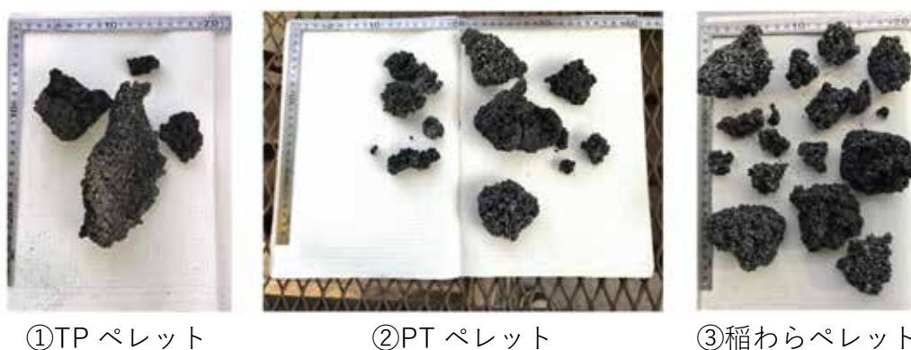
図 4-9 燃焼試験後に炉内に残っていたクリンカ
