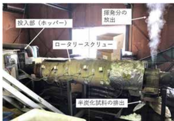
図 3-4 スクリュー炉
