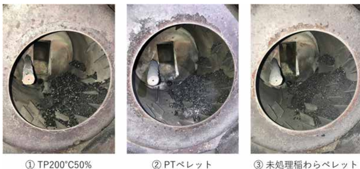
図 4-8 炉内の温度が下がりきった後の炉内の様子
