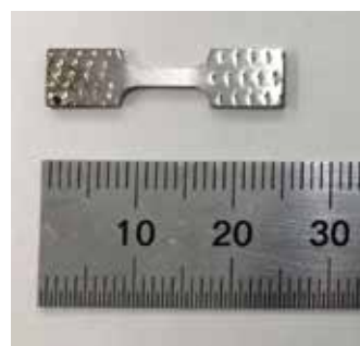
図 2 Fe-Mn-Mo 合金を 15% 引張り変形した試験片の概観（中心部の応力解析を行った）
