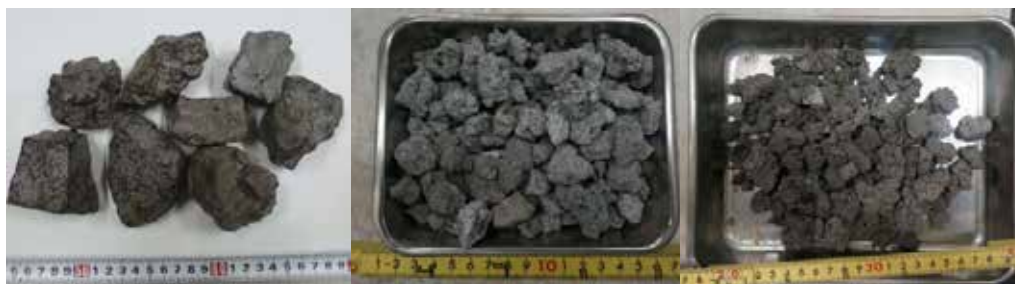
図 2-1-1. 使用した製鋼スラグ
