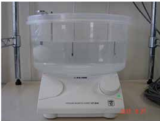
図 3.4 石膏球流速検量水槽実験
