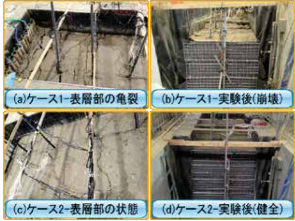
図-9 表層部の状態および実験後の全景(ケース1,2)
