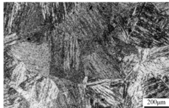
Fig. 2: 低炭素鋼ラスマルテンサイトの光学顕微鏡写真
