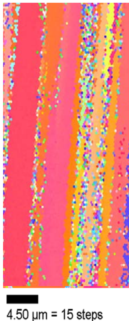
図18 グラフォ処理した基板上Ni膜のEBSP方位解析図形
