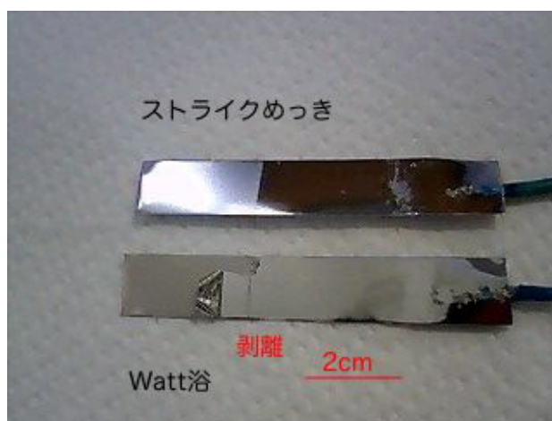
図2. ストライク浴とワット浴によるNiメッキの密着性評価結果。ワット浴では剥離が起こっている。
