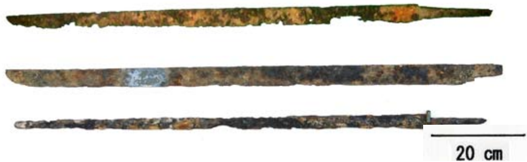
図1 古墳から出土した古代刀。上から本研究に用いた試料B、中が試料A、下は両刃の参考図(著者蔵)
