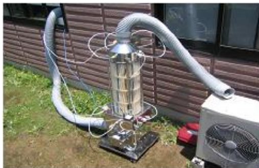
写真 5 太陽光による酸化チタン光触媒を用いた歯車型拡散スクラバーの HCHO 除去実験
