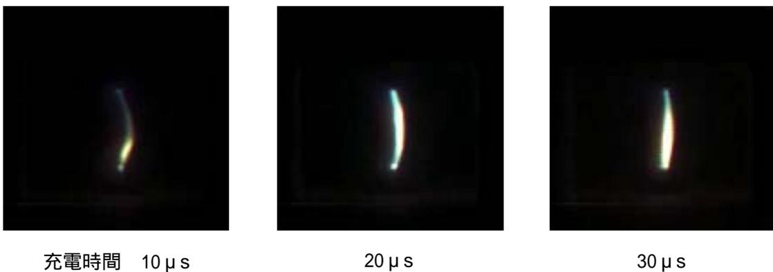
図5 放電プラズマによる燃料改質の様子
